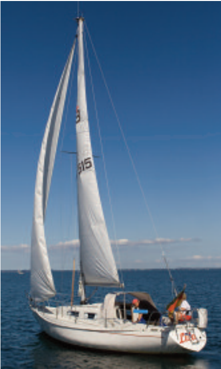
Typisch IOR-Design: Rumpfwölbung nach außen und positiver Spiegel am Heck
